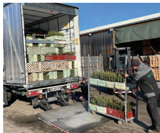
I nostri camion sono dotati di portellone-mobile, che facilita lo scarico.
